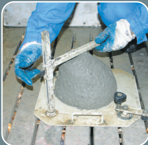
^ CXB® EN 206 : un affaissement au cône d'Abrams compris entre 100 et 150 mm.
